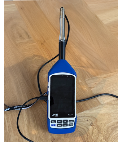
Abb. 2: Schallpegelmesser NTi XL3 zur Erfassung von Luft- und Trittschall
