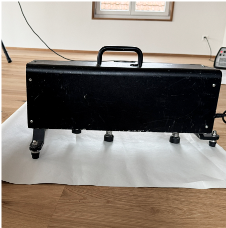
Abb. 1: Genormte Trittschall-Klopfmaschine für Messungen nach SIA 181 / ISO 10140
